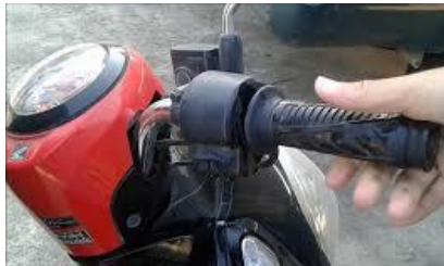
แฮนด์แรงเครื่องยนต์ใช้ผิวสัมผัสช่วยยึดเกาะ รอยนิ้วมือเพิ่มแรงเสียดทานในการยึดจับ
