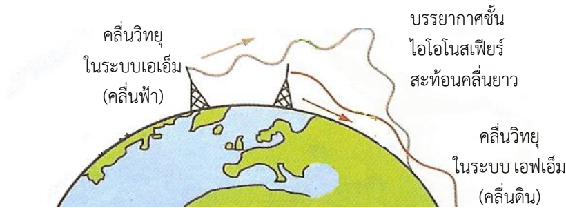
ภาพที่ 8.6 การส่งสัญญาณของคลื่นวิทยุในระบบเอเอ็ม และเอฟเอ็ม ที่มา (ประมวล ศิริพันธ์แก้ว, 2547, หน้า 215)
