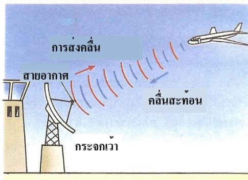
ภาพที่ 7.14 คลื่นไมโครเวฟ หาตำแหน่งวัตถุด้วยหลักการสะท้อนของคลื่น ที่มา (ประมวล ศิริพันธ์แก้ว และวิสูตรพึ้งเย็น, 2547, หน้า 447)
