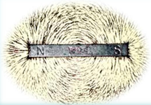
แสดงการเรียงตัวเป็นเส้นของผงตะไบเหล็ก
