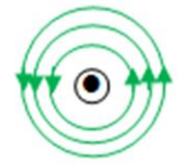
(ข.) กระแสไหลออกจากพื้นที่หน้าตัดตัวนำ
